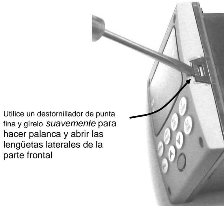
Utilice un destornillador de punta fina y gírelo *suavemente* para hacer palanca y abrir las lengüetas laterales de la parte frontal
